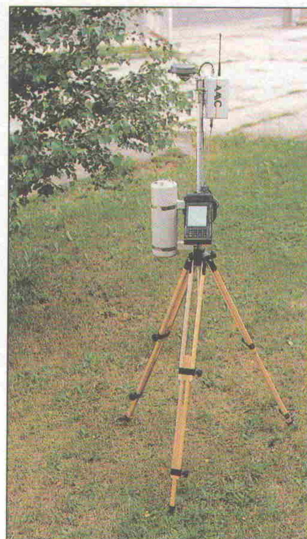
Bild 10. Der mobile Teil des Pordos-Systems; neben dem Rechner der Sensor für Radioaktivität und oben der DGPS-Empfänger und die GPS-Antenne.
