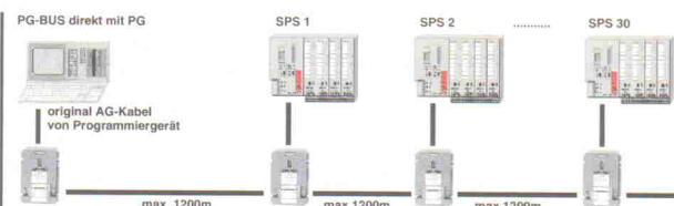
zentrale SPS-Programmierung und Diagnose mit dem PG über ein 4-Drahtkabel von bis zu 30 S5-Steuerungen ohne extra Software
